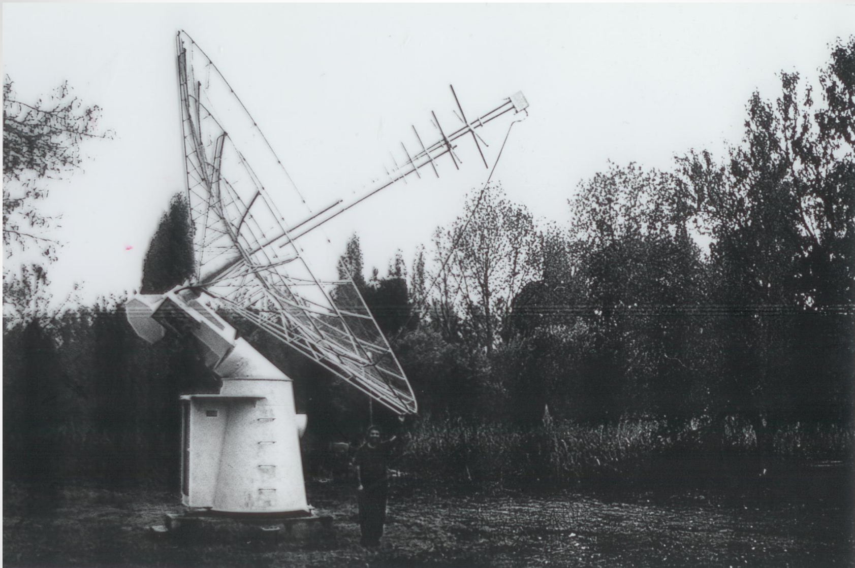
Παραβολική Λογαριθμική κεραία του ARTEMIS IV στο σταθμό Θερμοπυλών
